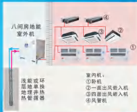
八间房暖冷一体化地能热宝系统
